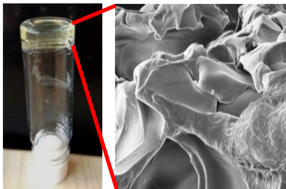
Figure 2. Hydrogel contenant de l'acide aminobutyrique en tant que co-monomère ; pilulier retourné et SEM.
