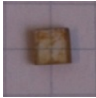
FIGURE 2.33: Photographie d'un verre contenant de l'argent ayant subi un traitement thermique à 350°C après irradiation par un rayonnement gamma.
