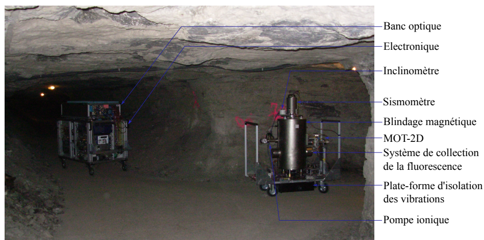
FIG. 2.1 – Photographie du CAG en déplacement dans la mine dans laquelle est installé le laboratoire souterrain de géophysique de l’université du Luxembourg. Sur la partie gauche se trouve le banc optique posé sur le bloc d’électronique et sur la partie droite la chambre à vide et son système d’isolation.
