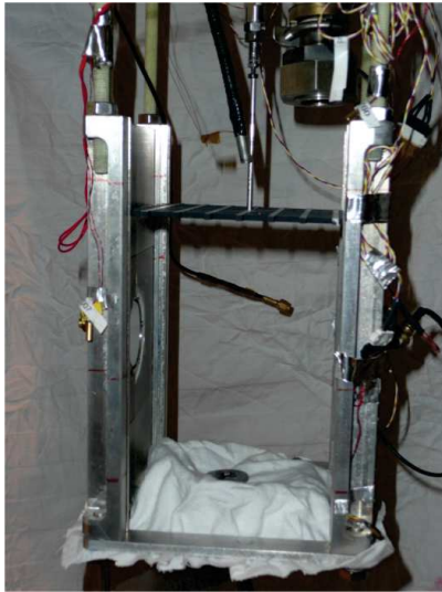
FIGURE II.14 – Système de récupération des particules : (a) position basse. (b) position haute (phase d'injection) avec en violet l'impulsion donnée aux particules.
