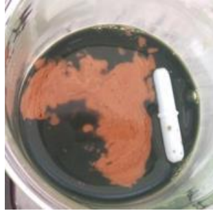
Figure III.24 : Précipité orange observé après ajout de soude dans une boue de type Fukushima
