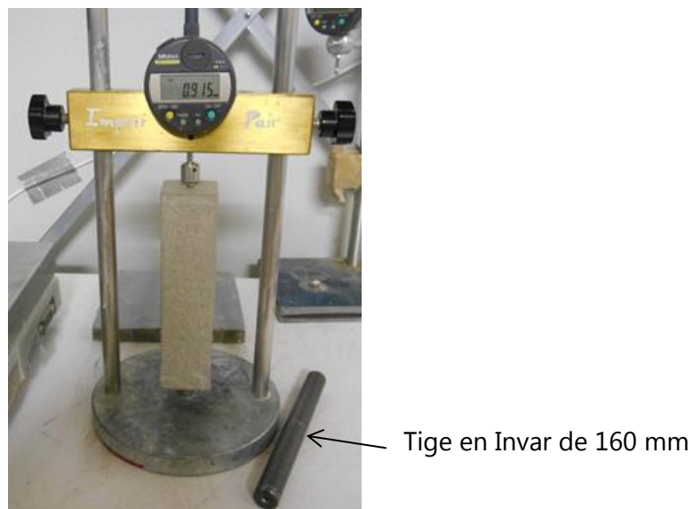
Figure II.17 : Dispositif pour les essais de variations dimensionnelles.
