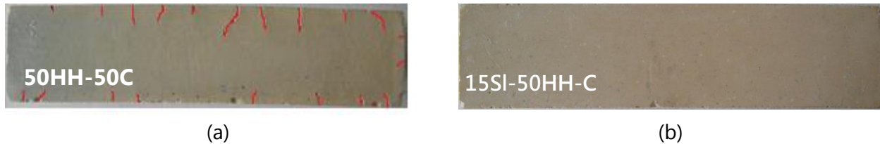
Figure V.11 : Eprouvettes servant aux mesures d'expansion (a) 50HH-50C et (b) 15SI-50HH-C après 72 jours de cure en condition humide.
