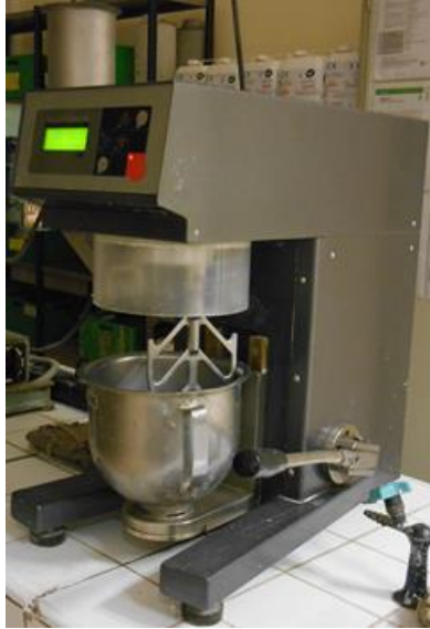
Figure II.5 : Malaxeur à mortier normalisé de capacité 5 l.
