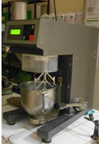
**Figure II.5 : Malaxeur à mortier normalisé de capacité 5 l.**
