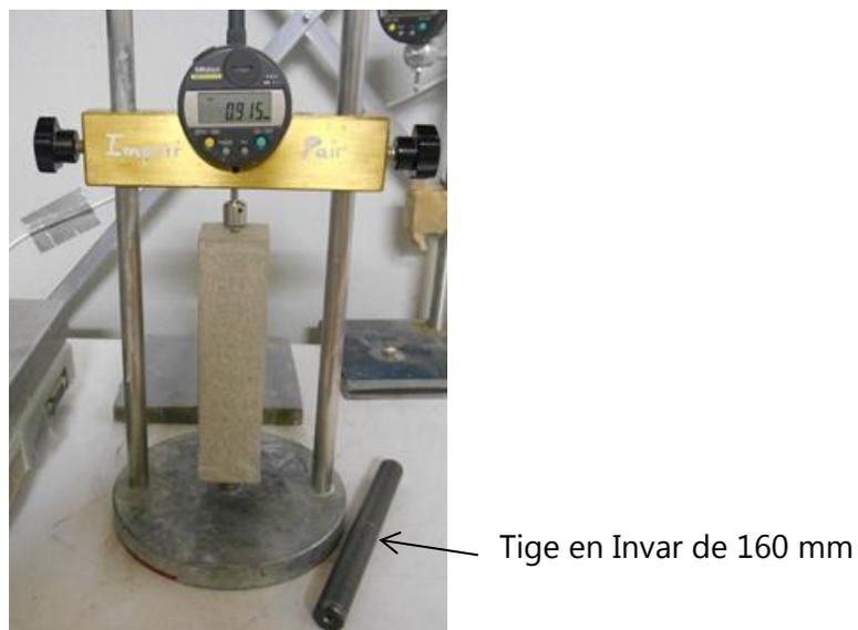
**Figure II.17 : Dispositif pour les essais de variations dimensionnelles.**
