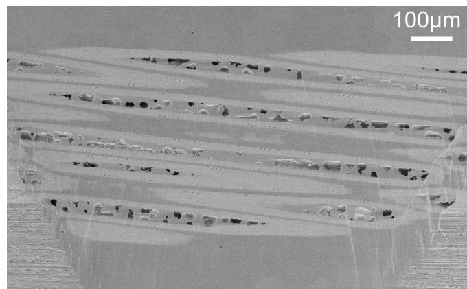
(a) Observation d'une zone abrasée complète du brin RRP.
