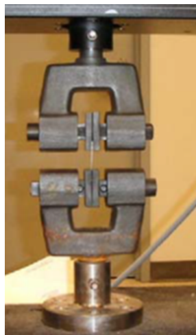
FIGURE II.10 – Dispositif de traction utilisé dans [Hanna et al., 2007] . On peut voir le brin serré directement dans les mors.
