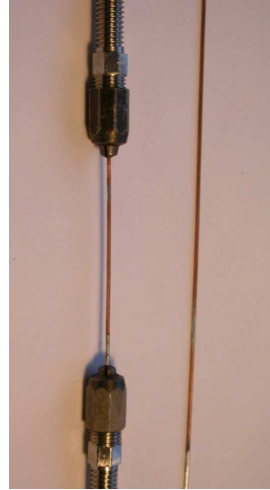
(b) Mandrins à quatre mâchoires avec dépôt d'argent sur le brin.
