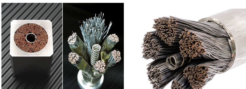
(a) CICC utilisé dans les bobines de champs toroïdal (TF). Vue en coupe (à gauche) et vue éclatée (à droite) [Dresner, 1995]. (b) Vue éclatée du CICC utilisée dans le solénoïde central (CS) [ITER, 2016].
