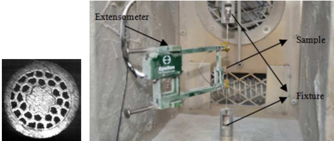
(a) Brin étudié. (b) Dispositif pour les essais de tractions à différentes températures.
