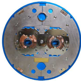
(a) Coupe d'un dipole du LHC [Evans, 2012].
