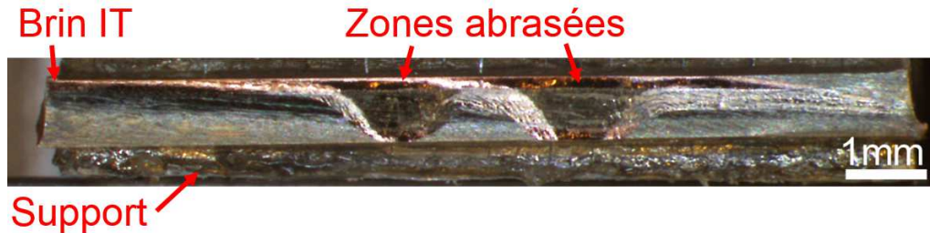
FIGURE IV.20 – Observation au microscope optique du brin IT après polissage au CP.
