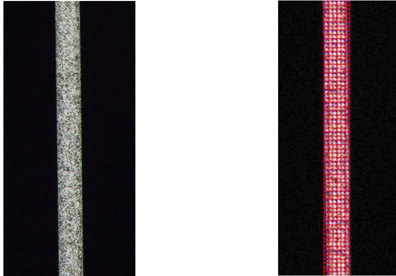
(a) Mouchetis appliqué sur la surface du brin. (b) Maillage de la surface du brin avec CORRELIQ4.
