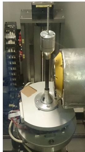
(b) Dispositif de traction installé dans le tomographe.
