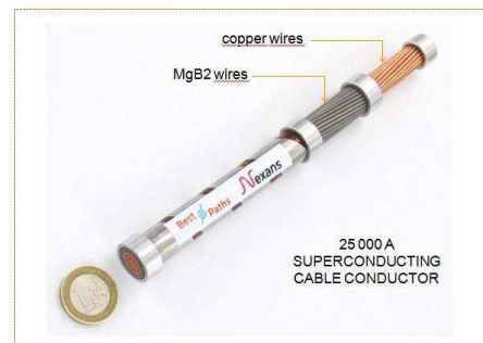
(b) Un des pétales Cu/ MgB_2 avec une pièce de 1 euros pour échelle.
