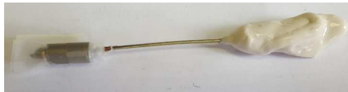
FIGURE II.22 – Protection des extrémités d'un échantillon afin de dissoudre la couronne.
