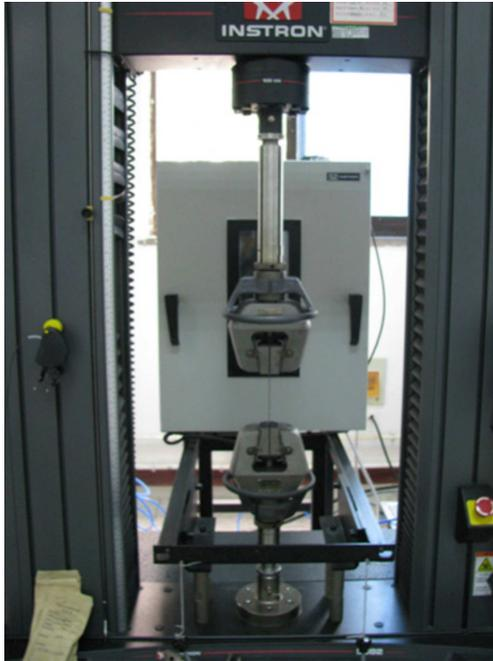
(a) Dispositif de traction utilisé.
