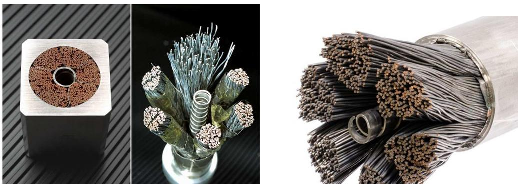
(a) CICC utilisé dans les bobines de champs toroïdal (TF). Vue en coupe (à gauche) et vue éclatée (à droite) [Dresner, 1995]. (b) Vue éclatée du CICC utilisée dans le solénoïde central (CS) [ITER, 2016].
