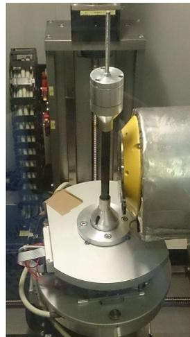
(b) Dispositif de traction installé dans le tomographe.
