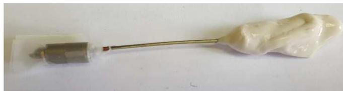
**FIGURE II.22** – Protection des extrémités d'un échantillon afin de dissoudre la couronne.
