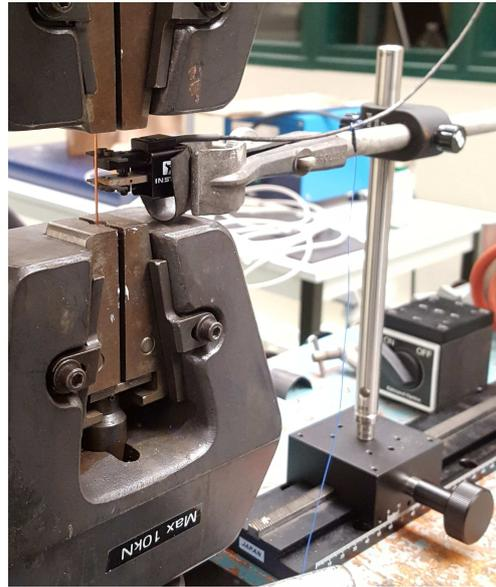
(b) Approche de l'extensomètre par une pince montée sur une crémaillère millimétrique.
