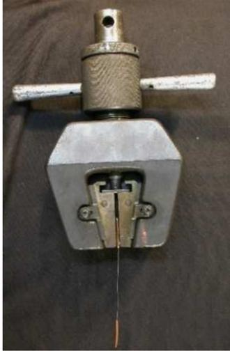
(a) Mors 100kN avec mordache plat. Deux tubes de cuivre sont insérés aux extrémités du brin.
