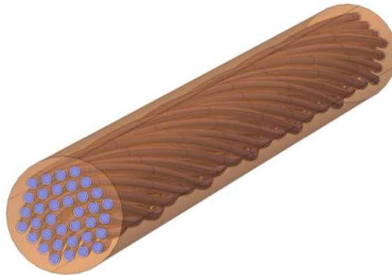
**FIGURE I.5** – Représentation d'un brin multifilamentaire par le modèle *Multi-filament twist* décrit dans [Wang *et al.*, 2016]. On peut y voir les filaments supraconducteurs (section bleue) twistés dans la matrice.
