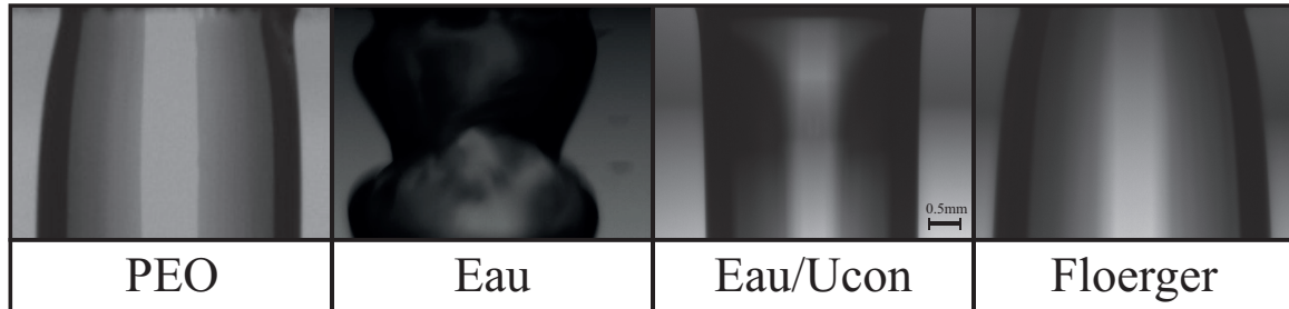
FIGURE 6.4 – Photographies de jets en sortie du trou pour différents fluides dans les premières secondes de l'écoulement. [ r = 1.75 mm ; h_0 = 11 cm] Fluides de gauche à droite : PEO/8M/50C* ; Eau ; Mélange Ucon/eau à 145 mPa.s ; Polymères Floerger /12M/56%/50C*.
