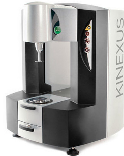
FIGURE 2.5 – Rhéomètre utilisé pour caractériser les fluides de cette thèse. Il s'agit d'un Kinexus ultra+ de la marque Malvern permettant de mesurer des couples entre 5 nN.m (0.5 nN.m en oscillations) et 250 mN.m. Dimensions : 490 mm × 485 mm × 680 mm.
