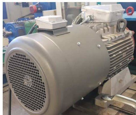
(b) Moteur du prototype avec la ventilation forcée
