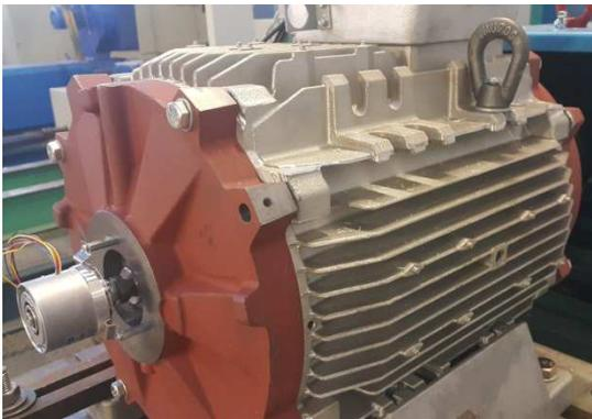
(a) Moteur du prototype assemblé
