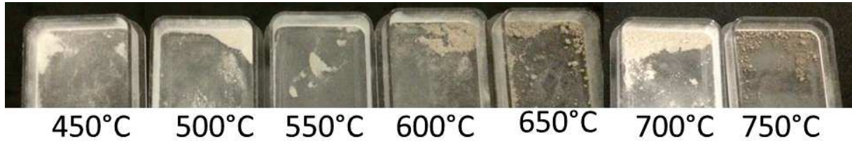
Figure 17 : Photographies des poudres de YAB SG-a recuites à différentes températures. Les différences de couleurs observées entre 650 et 700°C sont dues à des prises photographiques différentes.
