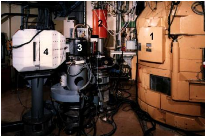
Figure III-21 : Photographie spectromètre 2T1 du laboratoire Léon Brillouin. (1) monochromateur, (2) table échantillon sur laquelle est fixé un cryostat, (3) analyseur et (4) détecteur.
