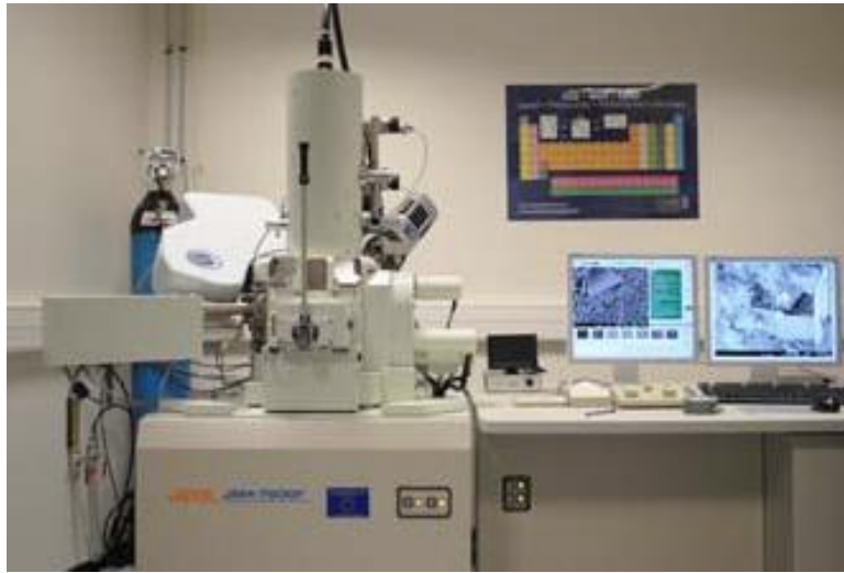
Figure III-5 : Microscope électronique à balayage JEOL J7600F de la Faculté des sciences de Nancy.
