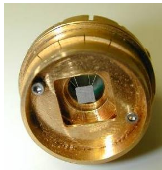
Figure III-12 : Porte-échantillon utilisé pour les mesures de C_p basses températures (PPMS)
