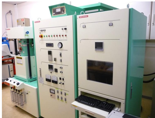
Figure IV-9 : Photographie du SPS Dr Sinter 515S de SPS Syntex Inc. installé à l'IJL.
