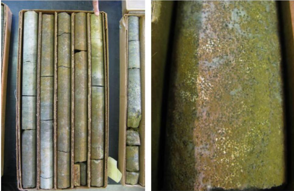
Figure 53 – Photo du niveau contenant les oolithes ferrugineuse sur la carotte de forage DR1-A
