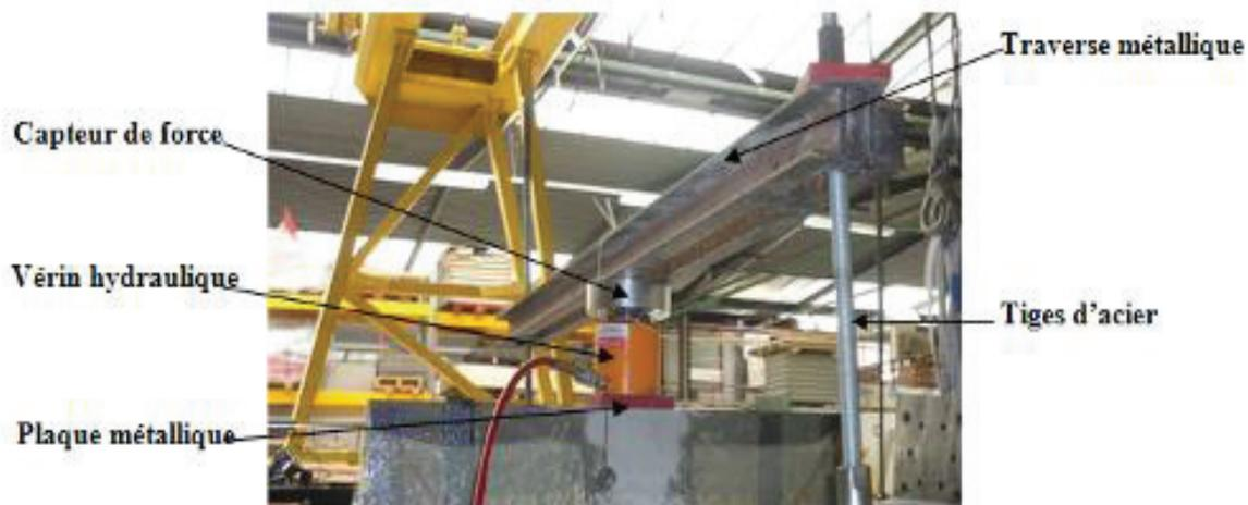
**Figure 3-13 : Dispositif de mise en charge verticale**
