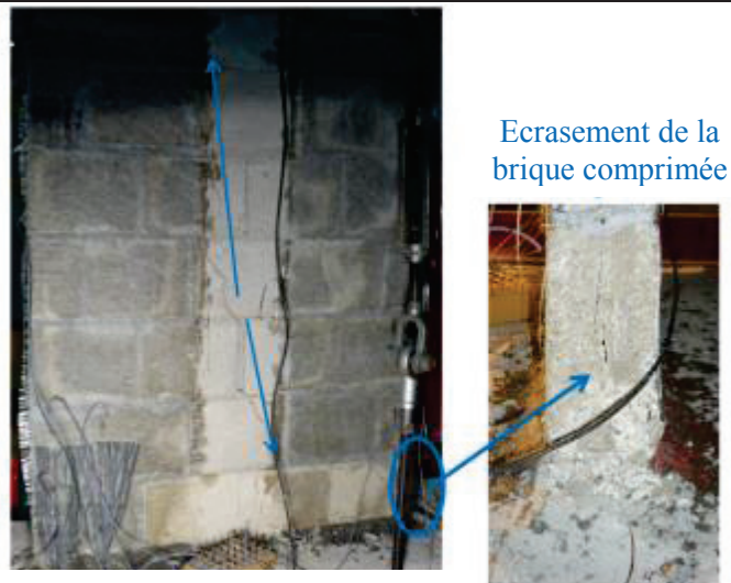
(b)- Rupture par cisaillement- flexion du mur MRC
