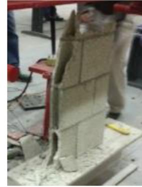
**Essai3****Figure AN2-23 : Modes de rupture des spécimens sans arases**
