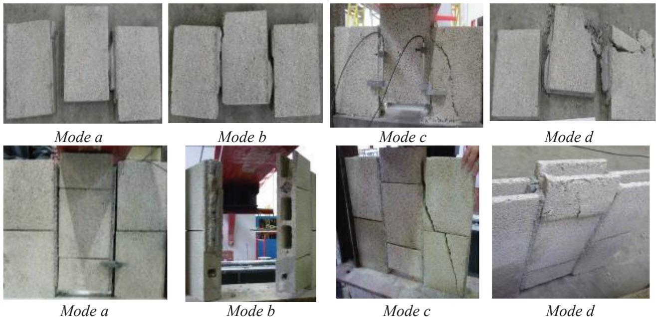
**Figure 2-14** : Modes de rupture sous cisaillement des spécimens sans joints horizontaux sur la première ligne et avec des joints horizontaux sur la seconde.
