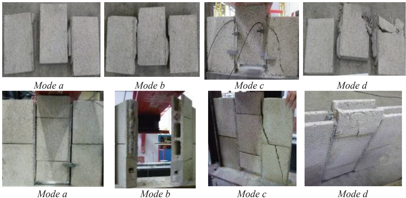
Figure 2-14 : Modes de rupture sous cisaillement des spécimens sans joints horizontaux sur la première ligne et avec des joints horizontaux sur la seconde.
