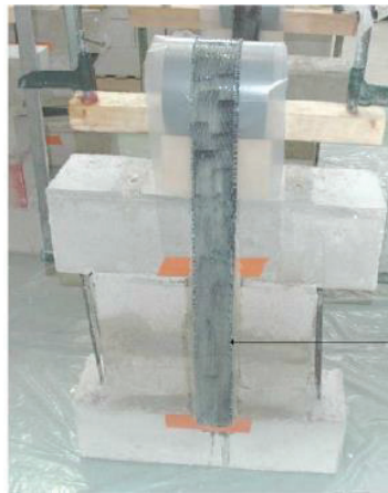
Figure 5-20 : Essai de caractérisation de la longueur d'ancrage de CFRP dans le renforcement des éléments de maçonnerie de briques en béton creux [SAH(2011)]
