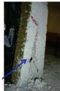
Ecrasement de la brique comprimée
