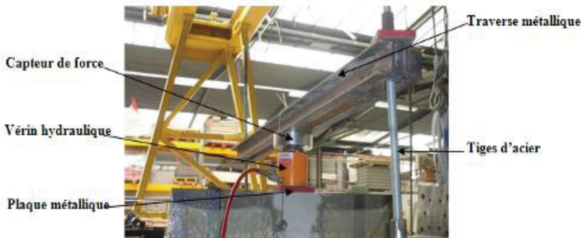
Figure 3-13 : Dispositif de mise en charge verticale
