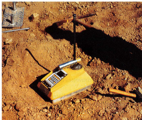
Figure I. 4 (à g.) Planche d'essai (Degoutte, 2002); (à d.) Gammadensimètre (Durand et al., 1999)
