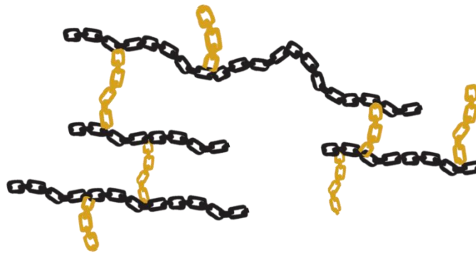
Figure 4 : Représentation schématique de liaisons des macromolécules d'un polymère thermodurcissable
