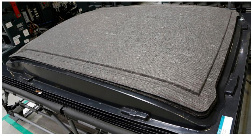
Figure 8 : Exemple de remise en forme de fibres de carbone recyclées par pyrolyse
