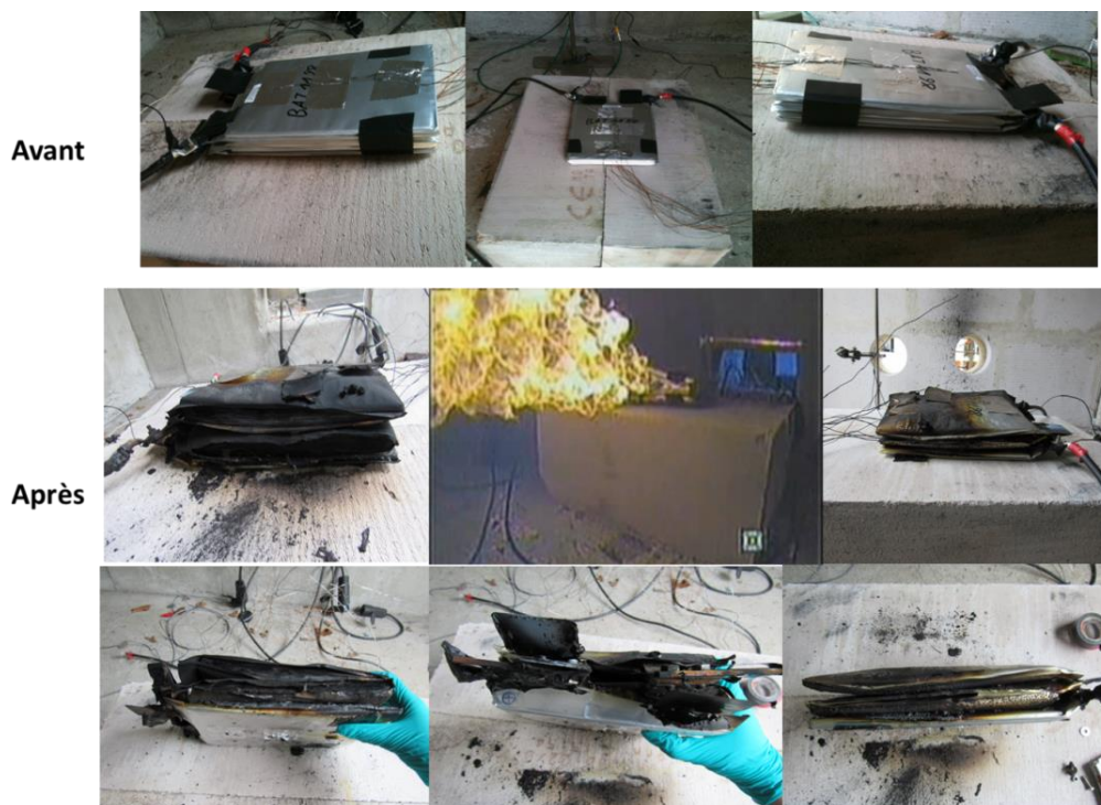
Figure 3.37. Clichés photographiques avant et après l'essai de surcharge du module PurePower
