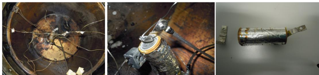
Figure 3.11. Clichés photographiques avant et après essai d'une cellule A123s (BAT717)
