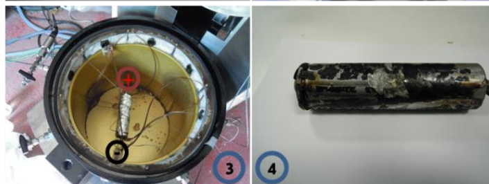
Figure 3.12. Clichés photographiques avant et après essai d'une cellule LifeBatt (BAT317)
