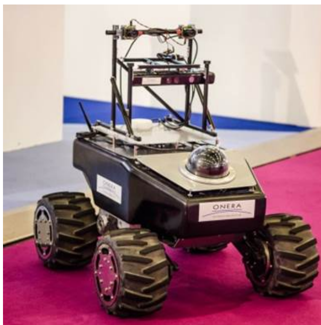
FIGURE 1.2 – Le robot DORA que nous utilisons est une plateforme Summit XL ©Robotnik, qui intègre une carte graphique Nvidia GT640 et un processeur Intel quad-core i7. Le banc stéréo doté d'une baseline de 18cm, est configuré pour enregistrer des images VGA à 20Hz.
