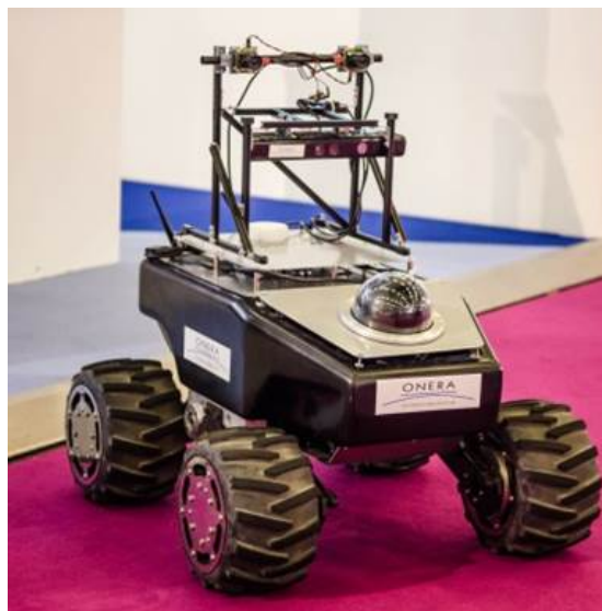
FIGURE 5.1 – Nous utilisons la plateforme Summit XL ©Robotnik, qui intègre une carte graphique Nvidia GT640 et un processeur Intel quad-core i7. Le banc stéréo doté d'une baseline de 18cm, est configuré pour enregistrer des images VGA à 20Hz.
