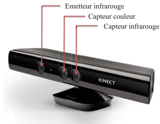
FIGURE 1.10 – Les composants d'une caméra KinectV1.
