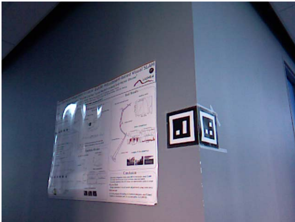
FIGURE 5.5 – Exemple de cible codée utilisée pour calculer la pose de la caméra par rapport à un repère fixé sur le modèle de la scène.
