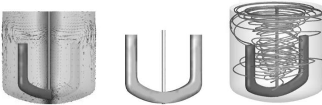
Figure 49 : Modèles d'écoulement pour un agitateur tangentiel type ancre (Uribe-Ramirez et al. , 2012).
