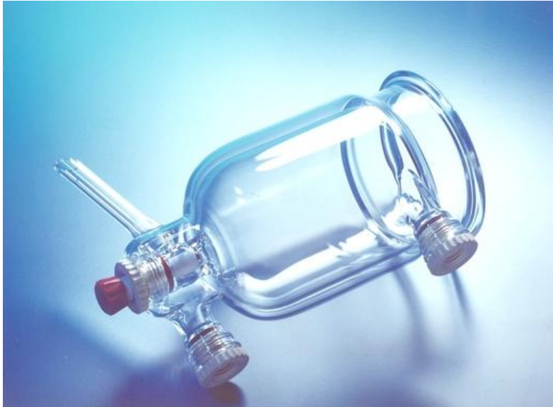
Figure 76 : Réacteur en verre borosilicaté à double enveloppe utilisé pour la validation ( http://www.verre-equipements.fr/reacteur-thermostate-2.html ).
