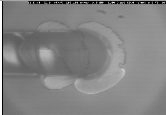
Figure 3.10 : écaillage d'un film nano-composite déposé sur un substrat de PC à 90°C et pour une vitesse de 0,03 \mu\text{m/s} (rupture transversale).
