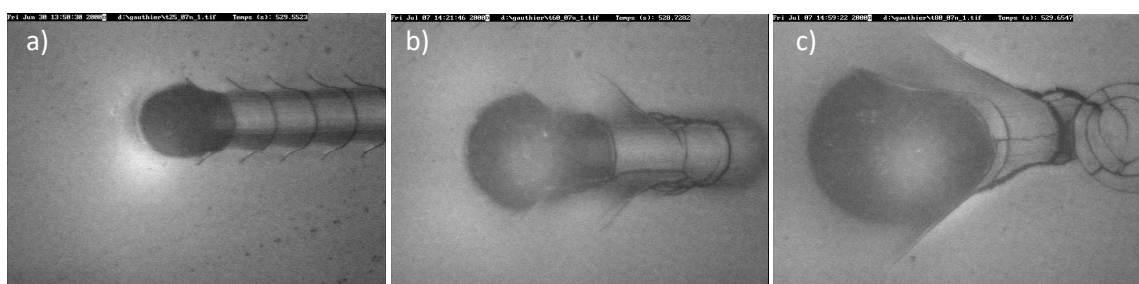
Figure 5.13 : images in-situ de la rayure d'un CR39 revêtu. a) à 20^\circ\text{C} , b) à 60^\circ\text{C} et c) à 80^\circ\text{C} .
