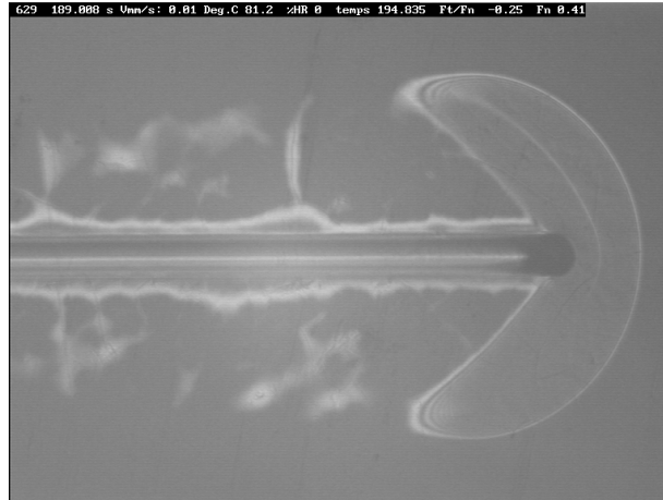
Figure 2.18 : cloquage d'un film [48].
