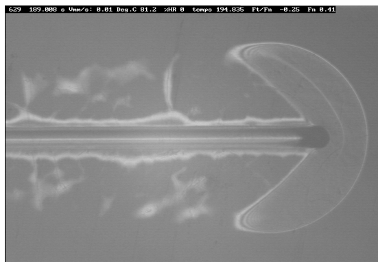
Figure 3.11 : cloquage d'un film nano-composite déposé sur un PC rayé par un indenteur sphérique R 116 \mu\text{m} à 10 \mu\text{m/s} pour une température de 90 °C (rupture interfaciale) [48,74].
