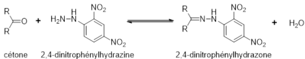
Figure II-12. Réaction d'une cétone avec la DNP
