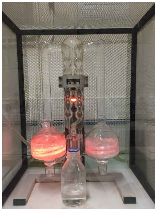
Figure III-18 Vue réelle de l'installation expérimentale pour la triple distillation de l'eau.
