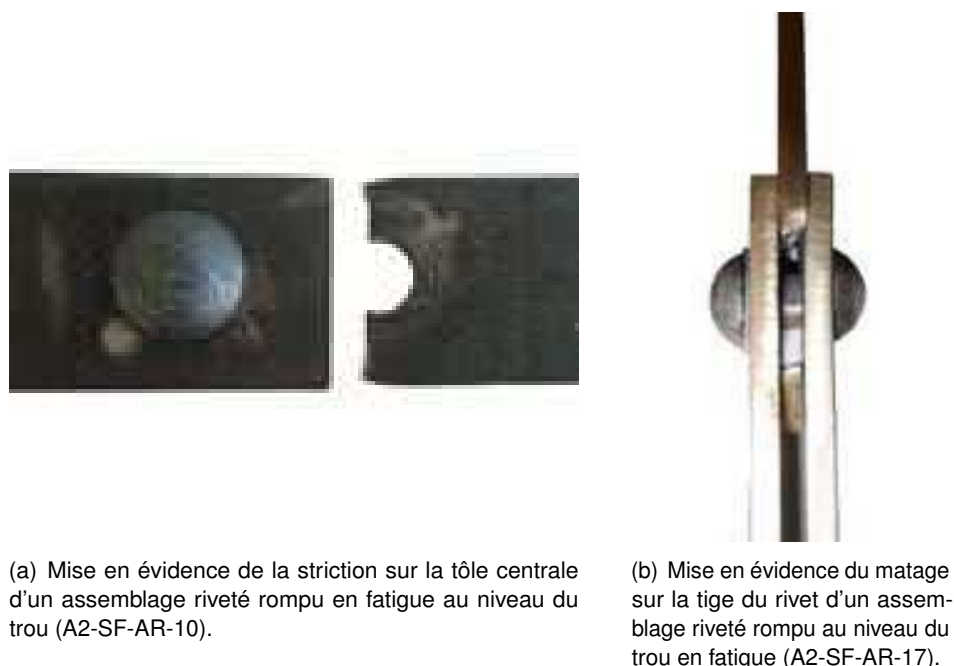
FIGURE 7.12 – Exemples de rupture en fatigue pour des éprouvettes du type détail constructif.
