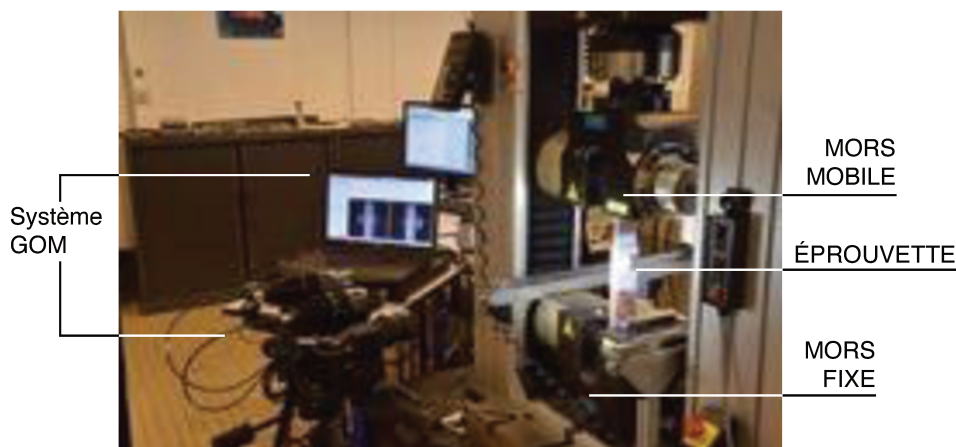
FIGURE 6.4 – Présentation du dispositif expérimental de mesure de champs déplacement 3D par corrélation d'images.
