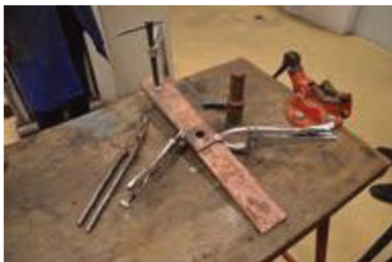
FIGURE 2.12 – Installation de serre-joints avant rivetage sur un assemblage mono-rivet à double recouvrement.
