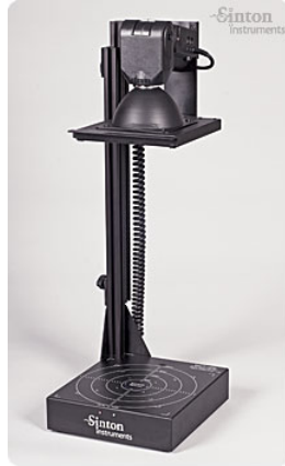
FIGURE 3.4.1 – Outil de caractérisation de durée de vie effective WCT-120 [SINTON CONSULTING].
