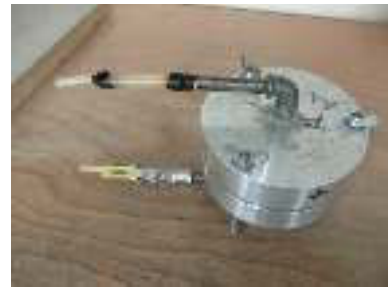
Remettre la pièce supérieure et verrouiller à l'aide des vis à ailette
