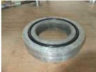
Placer un joint sur la pièce centrale
