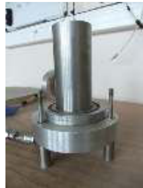
Tasser le sol au cours du remplissage à l'aide d'un cylindre métallique ajusté
