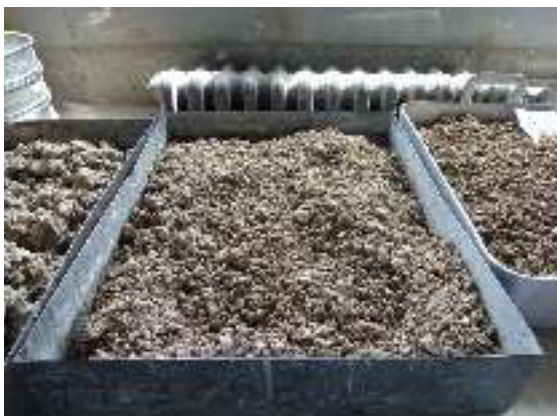
Si nécessaire le sol est séché à l'air
