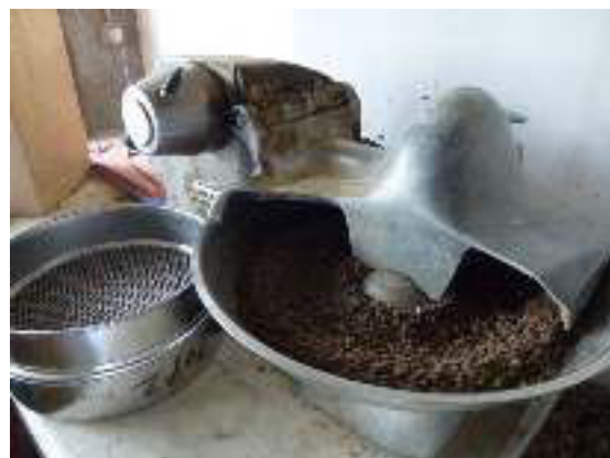
Puis le sol est mélangé et les mottes brisées
