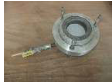
Placer la pièce centrale avec le joint sur la pièce inférieure avec le filtre
