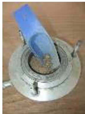
Placer le sol dans la pièce centrale
