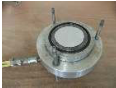
Placer un filtre et un joint
