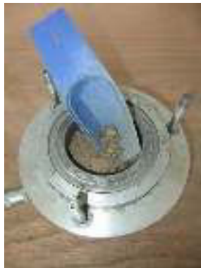
Placer le sol dans la pièce centrale
