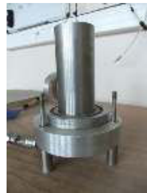
Tasser le sol au cours du remplissage à l'aide d'un cylindre métallique ajusté
