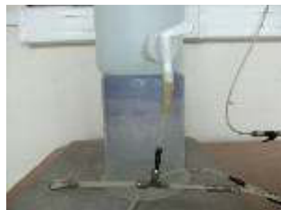
Le bidon est équipé d'une double sortie permettant de brancher deux blocs
