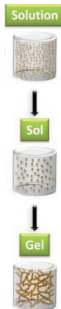
Figure 1 : Principe simplifié du procédé sol-gel
