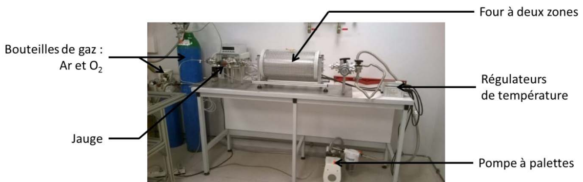
Figure II-4 : Photo du dispositif utilisé pour la synthèse CVS.
