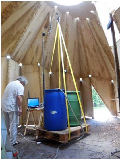
Figure 7.9 - Mesure expérimentale de la raideur en un point.
