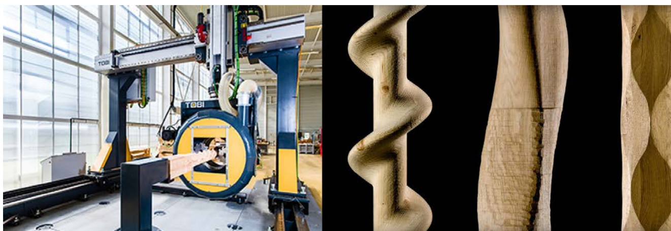
Figure A2.17 - Procédé «TOBI» (Tour à Bois Innovant) permettant un fraisage épicycloïdal multidirectionnel. Société d'Innovation et d'Ingénierie en Machines-Outils (SIIMO).
