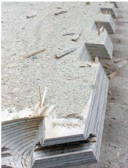
Figure 3.14 - Aspect brut de l'usinage : éclatements du bois et usinage non abouti.
