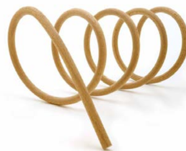
Figure A3.4 - Benywood, tourillon de hêtre cintré à froid. Disponible à l'adresse : http://www.l-atelier-bois.com/bendywood/1533
