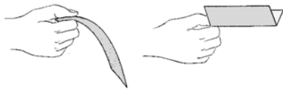
Figure 1.12 - Le pli de la feuille de papier permet d'absorber les contraintes de flexion. D'après (Salvadori, 1976, p. 185).
