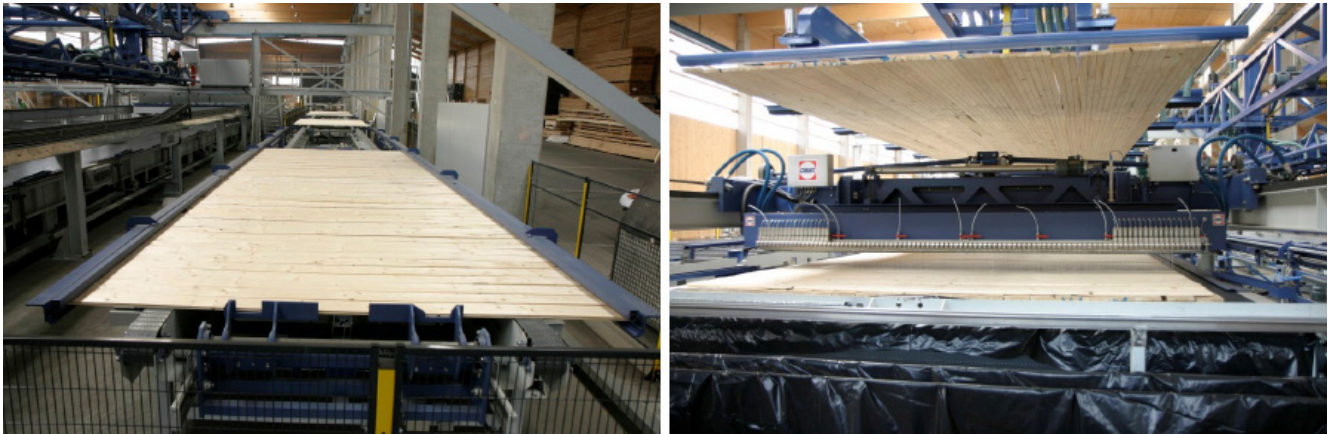
Figure 2.10 - Production d'un panneau de CLT: encollage et positionnement des couches croisées de planches. Disponible à l'adresse : https://www.holzkurier.com/schnittholz/2013/07/ein_klebstoff_fuerzinkefugeflaeche.html [consulté le 22 mai 2017]
