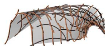
Figure 6 - . Projet ECO-CHUTE: structures fondées sur l'utilisation de composants en bois irréguliers peu ou pas transformés (branches, chutes d'industrie, bois de réutilisation...). D'après (Monier, 2011).
