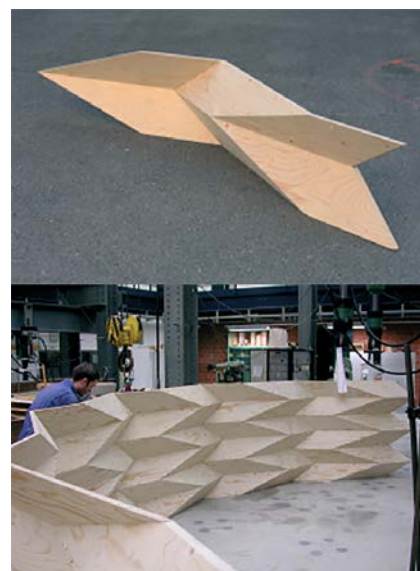
Figure 1 - Structure plissée en panneaux de bois reprenant le modèle de pliage «Miura Ori». D'après (Weinand, 2006, p. 16).
