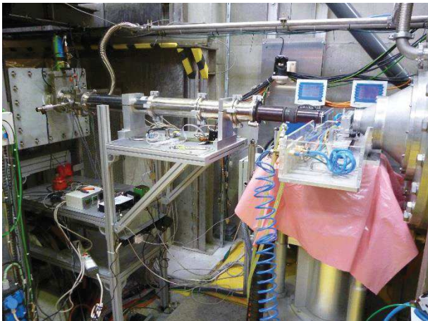
Figure 36 : Schéma du diffractomètre petits angles D22 (haut) et photos de la ligne D22 (bas) à l'Institut Laue Langevin (ILL, Grenoble).
