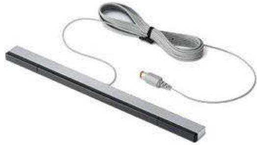
**Figure 92 : Sensor bar, accessoire nécessaire pour les Wiimotes.**
