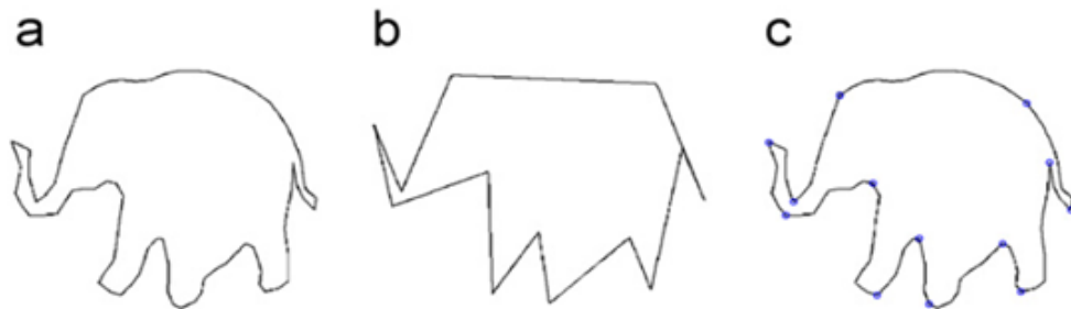
Figure 2.5 – Illustration de la simplification DCE. (a) : un contour entier d'éléphant; (b): le polygone qui représente le contour en (a) simplifié par DCE; et (c) : les sommets communs de (a) et (b) sont colorés en bleu.
