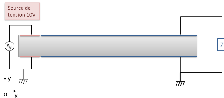
FIGURE 2.14 – Impédance de charge ( Z ) connectée aux électrodes (en bleue) de la plaque. Les électrodes représentées en rouge sont connectées à une source de tension alternative.
