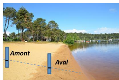
Figure 2. 11 : Représentation schématique de l'installation de piézomètres en bordure du lac de Lacanau.
