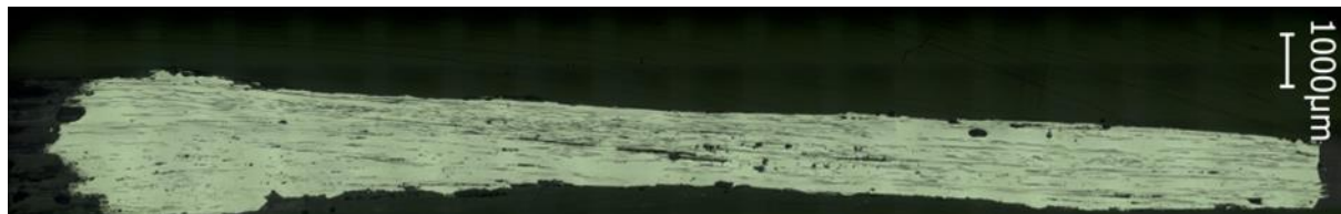
Figure 3-24 : Observation en microscopie optique d'une fibre de carbone infiltrée par capillarité après dépôt de K_2ZrF_6 en coupe longitudinale.
