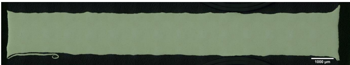
Figure 4-9 : Plan large d'un échantillon fritté avec un palier de 5 minutes à 500°C sous 50 MPa.
