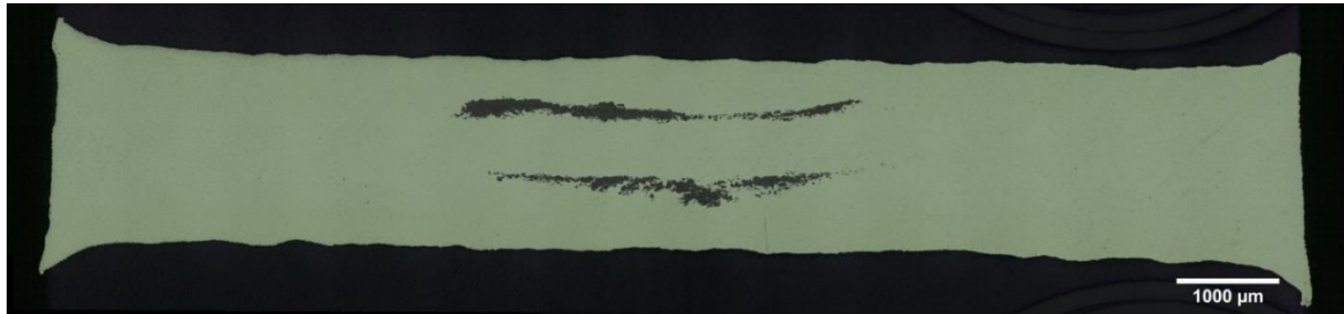
Figure 4-15 : Plan large en microscopie optique d'un échantillon poudre-fibres de carbone fritté à 500°C, 5 minutes sous 50 MPa
