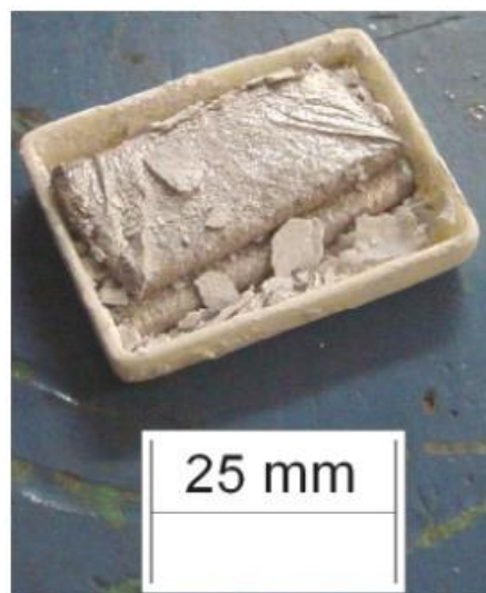
Figure 2-30 : Tentative d'élaboration de composite Al-C par voie fibre-feuillard (Durkin 2007).
