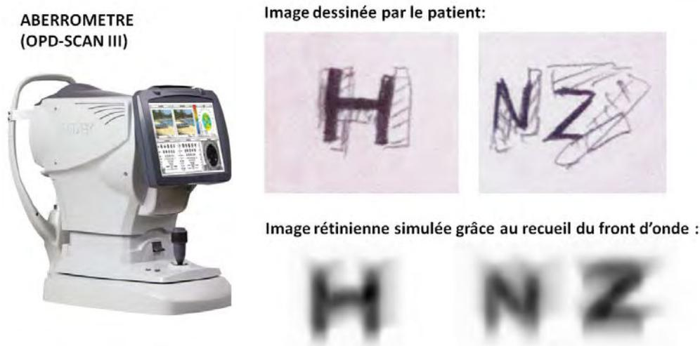
FIGURE 2 – Examen aberrométrique effectué par un aberromètre (instrument OPD-SCAN, Nidek, Japon).
