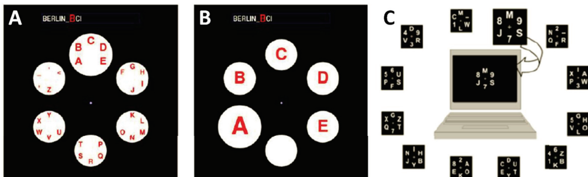
Figure 40 : Modes de stimulation ne nécessitant qu'une attention implicite sur la cible. (A) Mode proposé par Treder and Blankertz (2010) qui nécessite une sélection du groupe de lettre, suivi dans un deuxième temps (B) de la sélection de la lettre parmi ce groupe. (C) Mode proposé par Aloise et al. (2012a) dans lequel les lettres sont présentées en groupe à l'écran.
