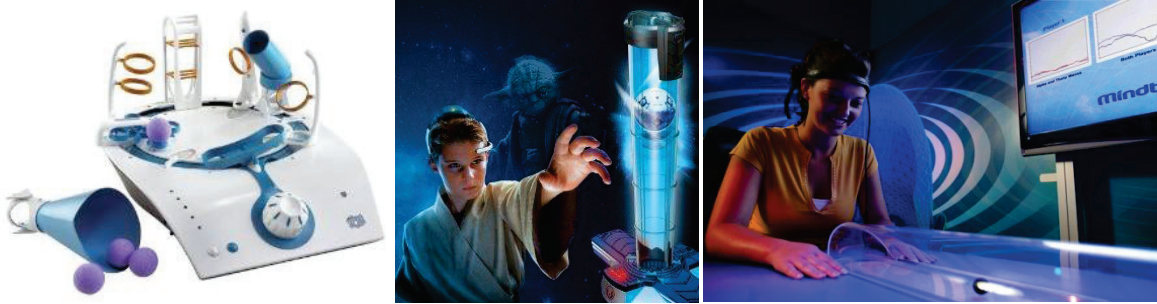
Figure 12 : Jeux Mindflex, Force trainer et Mindball qui consistent à se concentrer ou se détendre pour influencer la position d'une balle contrôlée par un jet d'air.
