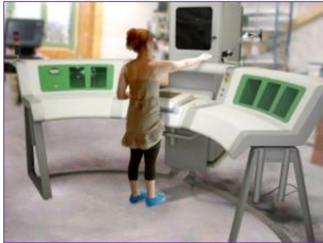
Figure 53 : Prototype physique fonctionnel du banc de test de cartes électroniques. L'ergonome a évalué dans cette dernière phase l'utilisabilité et l'accessibilité du nouveau banc de test.
