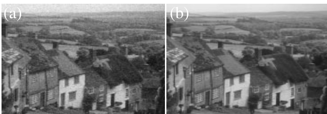
FIGURE 3.7 – Débruitage d'image par ondelettes : (a) image bruitée, et (b) image dé-bruitée [Chang et al., 2000].
