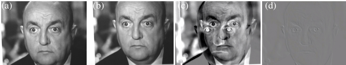
FIGURE 3.22 – [Conditions nominales] : Séquence d'images acquise pendant la réalisation d'une tâche de positionnement en utilisant la loi de commande développée : (a) image désirée, (b) image initiale, (c) image de différence initiale \mathbf{I}_{diff} , et (d) image de différence \mathbf{I}_{diff} après convergence.
