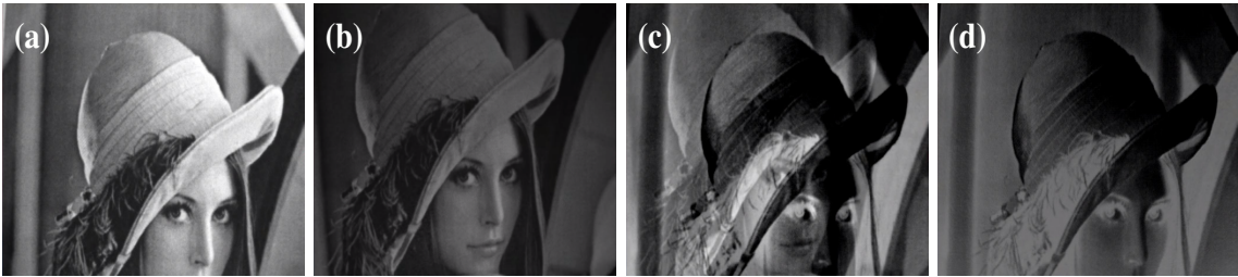
FIGURE 4.14 – [Variations d’éclairage] Séquence d’images prises pendant la réalisation d’une tâche de positionnement à la résolution 1/2 sur une scène 2D : (a) image désirée, (b) image initiale, (c) image de différence I_{diff} initiale, et (d) image de différence I_{diff} prise à la position finale.
