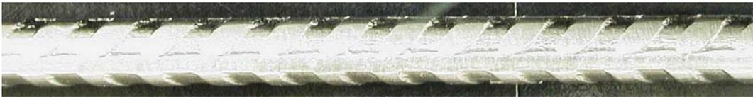
Figure II.1-3 : Format des barreaux utilisés pour la corrosion. Aspect après dégraissage.
