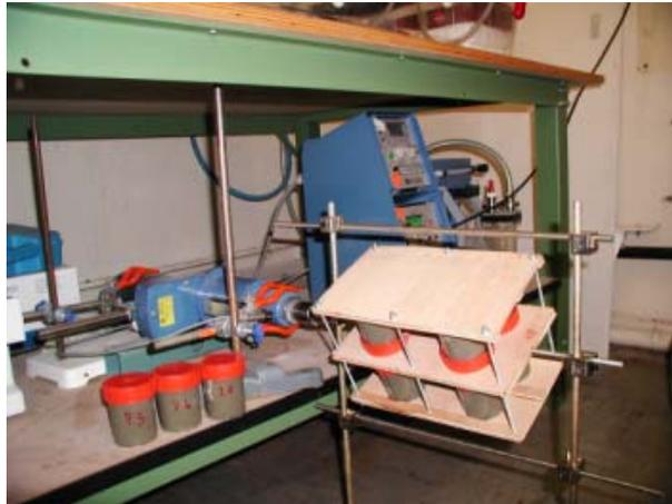
Figure II.1-4 : Image du système de retournement des échantillons de mortier pendant la prise.
