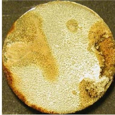
Figure III.3-4 : Observation macroscopique de l'échantillon d'acier FeE500 ( $\varnothing$  16 mm) après trois mois d'immersion dans S7, mise en évidence de zone de dépôt blanc.
