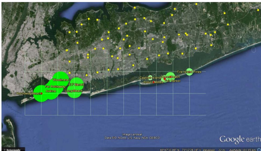
FIGURE 6.17 – Cartographie des niveaux de risque d’ennement d’équipements électriques estimés par un réseau bayésien suite à un risque inondation (LUNA et al. , 2015). Les cercles verts, de taille différente, représentent les différentes valeurs des probabilités calculées.
