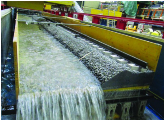
(a) Maquette à l'échelle \frac{1}{3} présentant un écoulement au niveau de la piste sans obstacle (PAMS CAPOCCIONI et al. , 2015)
