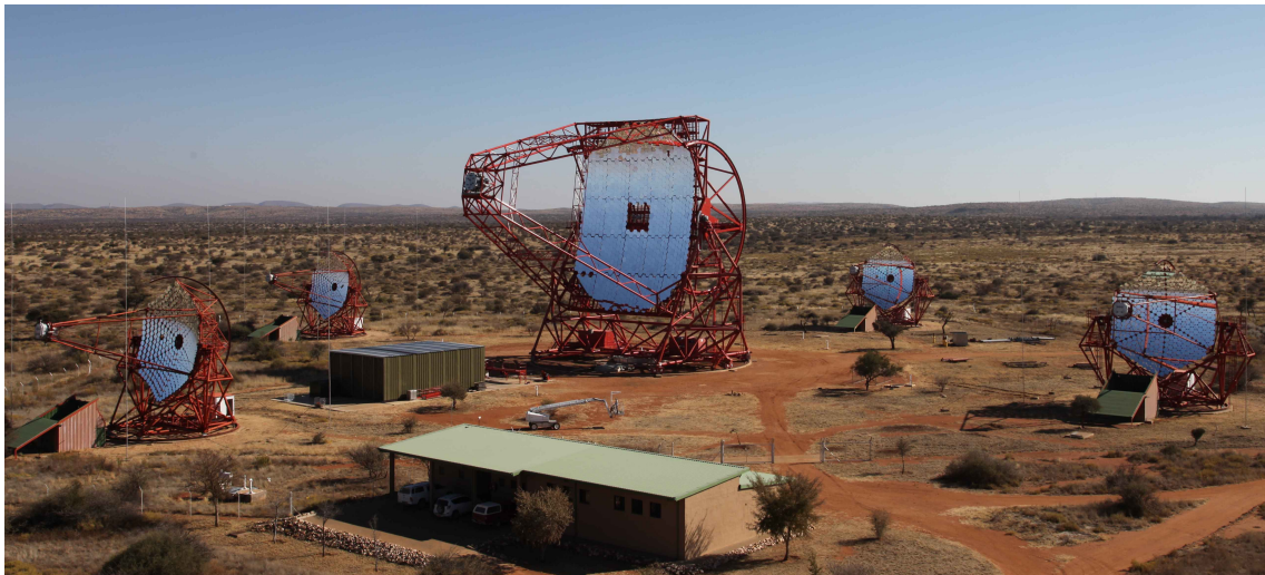
FIGURE 2.1 – Photographie du réseau hybride de télescopes Tcherenkov H.E.S.S.-II. (crédits : collaboration H.E.S.S.). En journée les télescopes sont dirigés vers le sud afin d'éviter toute réflexion directe de lumière solaire. De droite à gauche les télescopes sont CT1, CT2, CT5 (au centre), CT3 et CT4. Au premier plan se situe le bâtiment abritant la salle de contrôle et la ferme de calcul.
