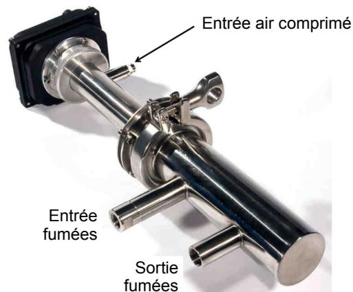
FIGURE C.1 – Photographie du Pegasor Particle Sensor (PPS)
