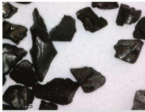
Figure 2.6 Cliché de grains de charbon actif PICA provenant d'une cartouche Sperian A2 avec un grossissement fois 40
