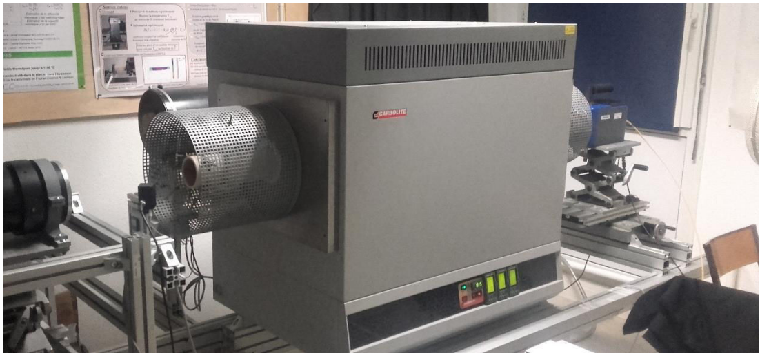
Banc de diffusivité haute température – LEMTA Université de Lorraine
